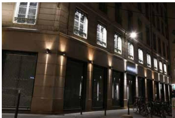
Éclairage partiel ; utilisation de ruban Led à visibilité directe ; effet de brulage (tache de lumière vive), marquage des faisceaux d'éclairage.
