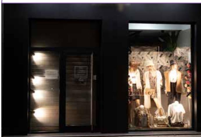
Éclairage trop contrasté et trop fort ; éclairage du plafond, contraste trop fort avec l'intérieur du magasin ; éclairage d'une partie occultées.
